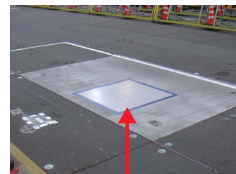
耐荷重型樹脂コンクリート製 送電コイル (東京駅前実証実験風景)
