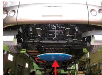
電動マイクロバスに車載された受電コイル
