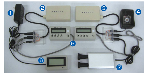
① 電源入力 ② 送電ユニット ③ 受電ユニット ④ DCアウトプット ⑤ データ送受信ユニット ⑥ 距離表示器 ⑦ 超音波距離計
